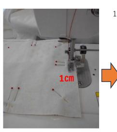
1 2. 布端から1cmに**ミシン**をかけます。(写真は**ステッチ定規**を使用) 1 3. ピンを取ります。
